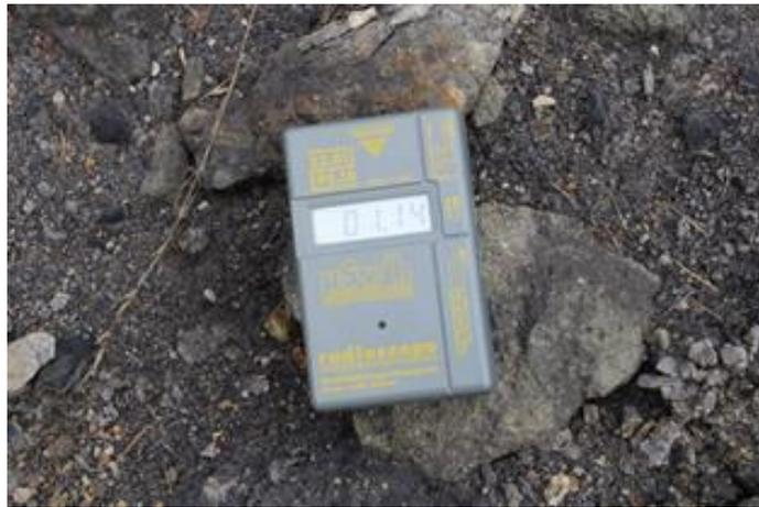
Abbildung 5: Ablagerung uranhaltiger Steinkohle auf der Collmberghalde; der Gamma-Strahlungswert betrug hier 1,14  $\mu$ Sv/h bei einer Umgebungsstrahlung von 0,14  $\mu$ Sv/h.
